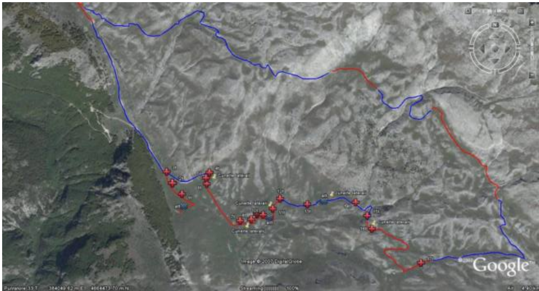
Ovindoli-CelanoAielli – Loc. Prati S.Maria- Prati Cusano- Monacesca – Mappa delle varie categorie di intervento di manutenzione della pista- In Rosso sono riportati i tratti di pista sistemati con ricarica di pietrame; in blu sono riportati i tratti sistemati senza ricarica e con manutenzione del piano viario; i punti con il simbolo della croce si riferiscono ai tagliacque; i simboli azzurri con onde (att) indicano gli
